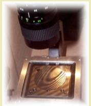
Sistema óptico por projeção de franjas e processamento digital de imagens para a medição tridimensional de peças com superfícies planas e quase planas.
